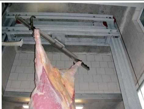
Photo 11. Rotation de la tige à crochets de levage
